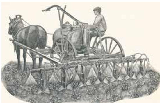
Afb. 14: Aardappelspuit met onder- en bovensproeiers, 1925 (Lit. 19, p172)
