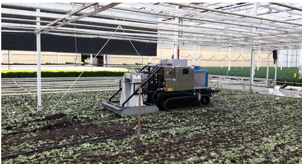
De Agriton ontsmet grond door middel van microgolven (foto: Koppert Machines).
