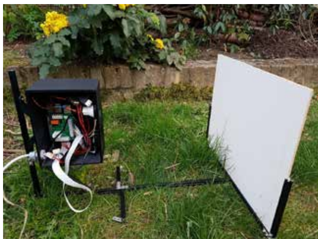
Een prototype van de cameraval voor het automatisch tellen van insecten.
