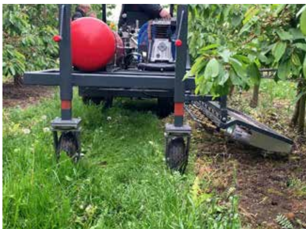
Hete-luchtstralers worden gebruikt om onkruid te bestrijden op de zwartstrook in een boomgaard (foto: WeedControl).
