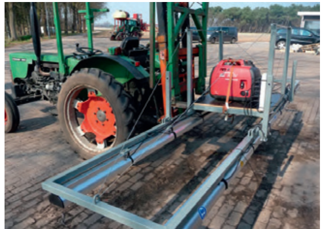
Het eerste prototype van de UV-machine voor aardbeien, eind 2011.
