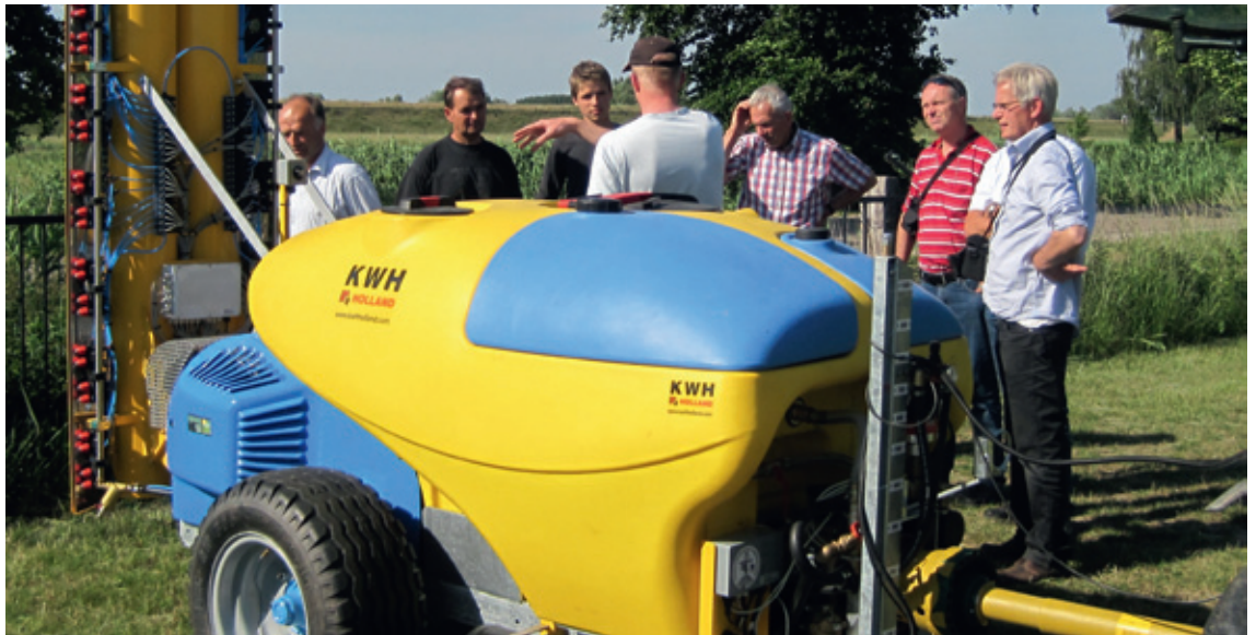
Figuur 2. Dwaarsstroomspuit met sensoren. Bron: PPO.
