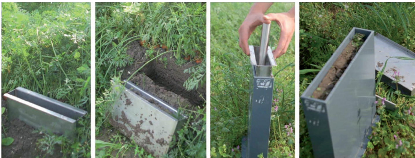
Figuur 5. Het nemen van ongestoorte grondmonsters voor de bepaling van bodemweerbaarheid.
