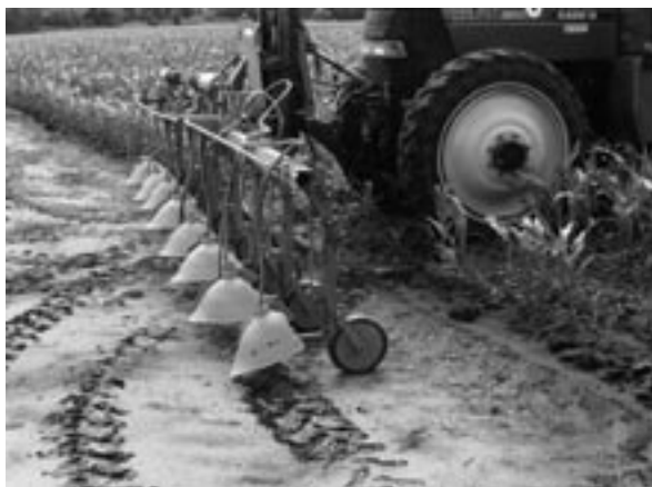
Bespuiting van haagwinde in maïs met driftarme spuitdoppen. Het beste resultaat wordt verkregen door een combinatie van chemische en mechanische bestrijding.
