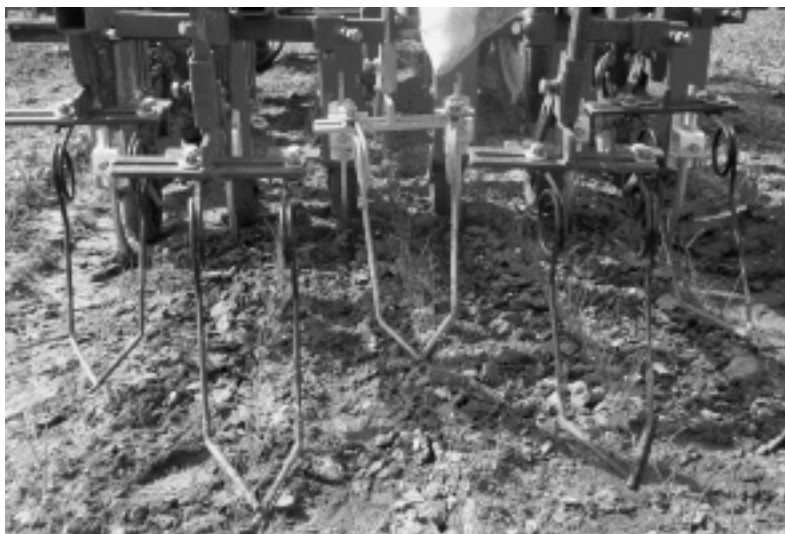
Figuur 2. Torsiewieders vlak voor inzet in zaaiui.
