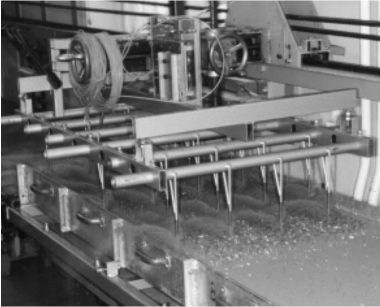
Figuur 2: Model-eg bewerkt grondbakken met planten in het laboratorium.
